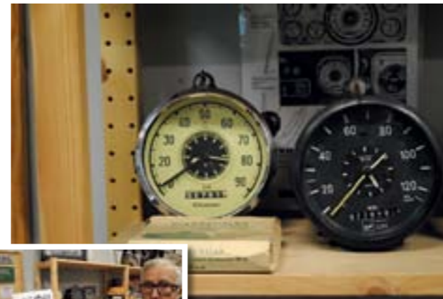
En av de första färdskrivarna – självklart med bevarad original-förpackning och bruksanvisning.
