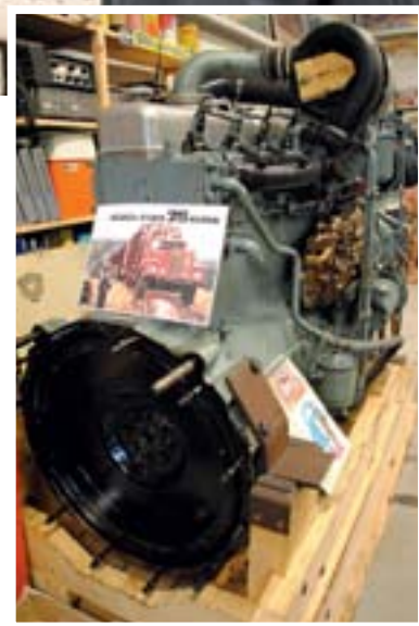
Scania-Vabis första turbomotor för lastbilar. Från 1961 och i nyskick.
