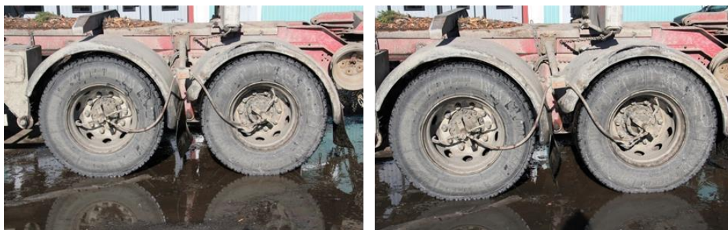
Figur 22 Däckets styvhet och kontaktyta kan ändras via TPCS. Foto: J. Granlund.
