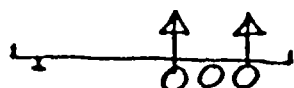
Fig 5: Påhängsvagn. Trippelboggi singelmontage 385/65R22,5. Axelavstånd 1,3+1,3m. Luftfjädring. Boggilyft axel 1 och 3. Däcktryck REK. Axeltryck varierar.
